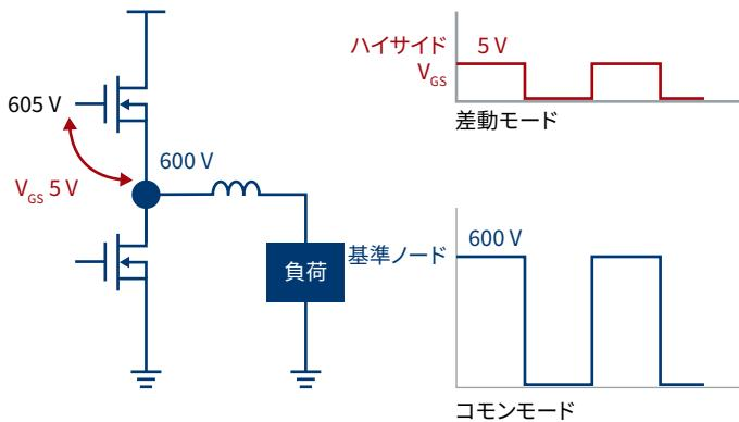
絶縁された電力変換の設計では、コモングランドがないためにDUTがフローティング状態になります。アース基準のある測定セットアップでは大きなグラウンドループが形成され、それにより、コモンモードノイズが結合して繊細なテスト結果に影響を及ぼす可能性があります。これは特に、高電力、3相インバータ、モータードライブの設計においてよく起こる問題です。
