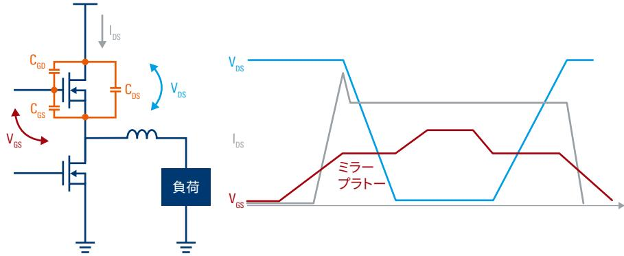
以下のスクリーンショットは、R&S®RT-ZISOでハイサイドのゲート - ソース間測定を捕捉したものです。1.85 nsのわずかな低下はミラープラトーです。他のプローブを使用すると、ハイサイドトランジスタのソースノードでのCMスイッチング信号がこれを隠してしまう場合があります。スイッチングノードが高速になると、変化する負荷に対する回路の応答時間が短縮され、トランジスタがオン／オフする際のスイッチング損失を効果的に低減させることができます。従来の高電圧差動プローブでは高周波でのCMRRが制限されるため、新しいテクノロジーやアーキテクチャーを使用する設計を測定する場合、課題に直面します。
