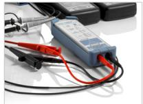
プローブチップとコネクタもCMRRに大きな影響を与えます。従来の高電圧差動プローブで要件を満たすのが困難である理由の1つは、プローブポイントへの接続が通常は4 mmのバナナプラグ／ジャックで、ワニ口クランプや長いニードルチップが使用される場合も多いからです。このような接続は、高電圧を使用する際の安全性の確保および十分な沿面距離を維持するために必要です。+ve端子と-ve端子間の信号経路にわずかでも不整合があると、コモンモードノイズを抑制する際に差動オペアンプの有効性が低下します。ケーブルが長い場合やシールドが不十分な場合にも、DUT周辺のコモンモードノイズの影響を受けやすくなります。
