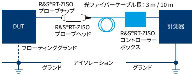
プローブヘッドからプローブレシーバーボックスまでの信号伝送は光接続で行われ、プローブヘッドに必要な電力はファイバーを介して伝送されます。プローブヘッドは外部電源を必要としないため、バッテリーのような独立した電源を使用しない限りは、別のコモンモードループが生じる可能性は限定的です。
