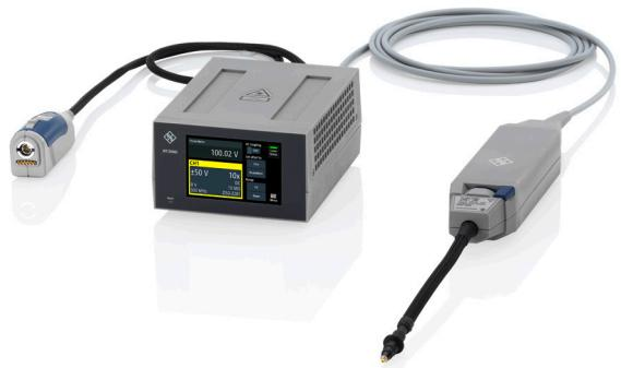
R&S®RT-ZISO 絶縁プローピング・システムは、BNCまたはSMAインターフェース(コネクタ)を備えたあらゆるオシロスコープに接続できます。プローブレシーバーは、プローブシステムの設定を制御したり表示したりするためのタッチスクリーン・ディスプレイを搭載しているので、プローブレンジやオフセット設定を容易に制御でき、接続されているプローブチップの表示も可能です。
