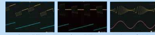
バースト発振を立ち上がりランプ波でDCオフセット変調
