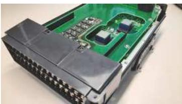
バッテリーパックを構成する各セルの電圧や、電極の温度を測定する際、対地間（入力チャンネル-大地間）や、計測モジュール間には高電圧が印加されます。
