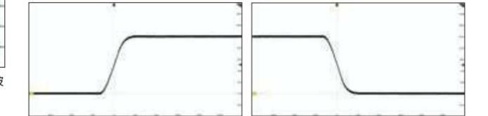
一般的な交流電源に比べて、立ち上がり時間が短く、変化の速い波形を高再現性で出力可能です。過渡応答の再現などに。
