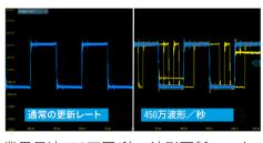
業界最速450万回/秒の波形更新レート で不具合波形を漏れなく観測!
