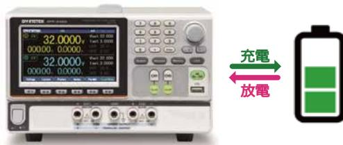
CH1とCH2は電子負荷モードに切り替え可能です。電子負荷機能は最大50WでCV/CC/CRの3つのモードに対応し、CVモードでは最大62VまでのCV動作、CCモードでは最大6.2AまでのCC動作(GPP-3060G、GPP-6030G)、CRモードでは最大1kΩまでのCR動作に対応しています。また、CH1を直流安定化電源として出力させながらCH2を電子負荷として動作させる等の混在した動作も可能です。(GPP-1326Gは最大6.2A, 100W)
