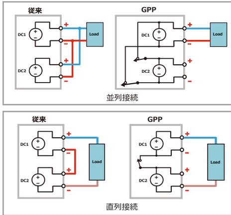
前モデルでも好評の内部接続での直列/並列接続をGPPシリーズでも搭載しました。通常の電源2台による直列/並列接続では、2台の間の相互接続が別途必要でしたが、内部での接続切替機能を設けることにより相互の外部接続を不要とし、より簡単に行えるようになっています。(GPP-1326G除く)
