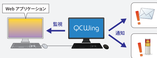
エラー発生時にメール送付、パトライト点灯
