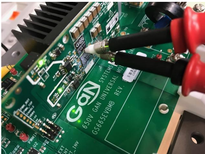
【図 11. 差動ペアプローブでプロービング】
