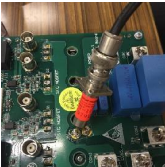
(a) 同軸型シャント抵抗取り付け例
