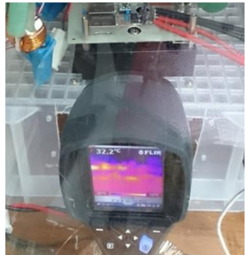
【図 58. インバータの電力測定時の温度計測】 (首都大学東京和田研究室)
