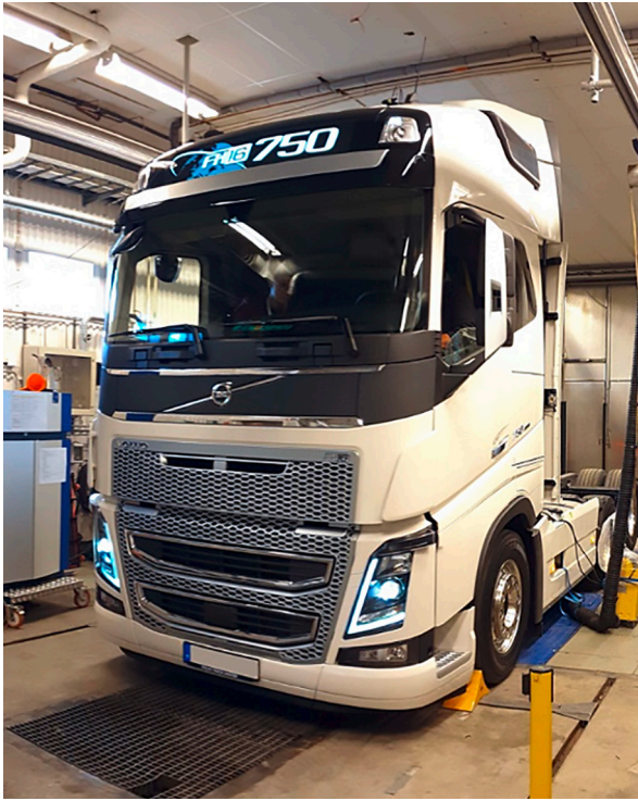
シャーシ動力計による予測ACCテストのための GNSSシミュレーションにおけるテスト車両
