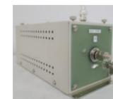
100kHz~110MHzの周波数範囲で、CISPR25に適合した擬似電源回路網
