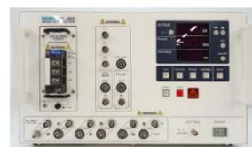
50Ω系終端器を試験器に内蔵し配線を容易にノイズ発生回路をフローティングにすることで、配線の煩わしさを軽減
