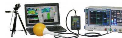
EPS-02シリーズは、カメラの画像から電磁界センサーの位置を色判別にて検出し、そのセンサーで測定した信号をリアルタイムで周波数解析するシステム
