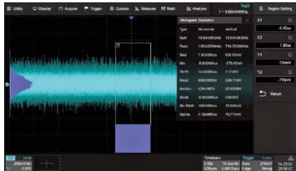
波形ヒストグラム機能は、波形の水平および垂直方向の統計表示を提供します。
