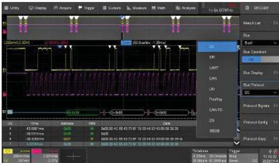
組み込みおよびオートモーティブなどのシリアルバス (I<sup>2</sup>C、SPI、UART、LIN、CAN、CAN FD、FlexRay、I<sup>2</sup>S、MIL-STD-1553B、SENT、Manchester (デコードのみ)) のトリガとデコードを装備しています。プロトコル情報は波形に合わせた時刻で表形式で表示するため、素早く直感的に情報を把握できます。
