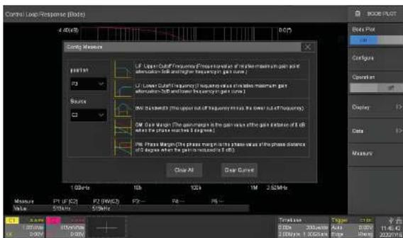
測定画面では、5つの一般的な測定値を設定できます。ハイサイドカットオフ周波数、ローサイドカットオフ周波数、帯域幅、ゲインマージンと位相マージン、ユーザーが設定可能な測定カーソルとCSV形式でエクスポートすることができる測定結果のテーブルがあります。
