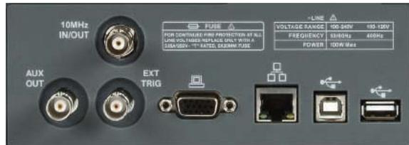
外部トリガ入力、パス/フェイルおよびトリガ出力、リモート制御用のUSBデバイス (USBTMC)、LAN を装備しています。
