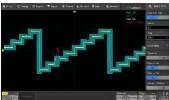
T3DSO3000は、1秒間に18,000回の合格/不合格テストを実行できるハードウェアベースのマスクテスト機能を装備しています。波形またはマスクエディタ機能から直接独自のマスクを定義できます。マスクは、履歴波形またはスクリーンショットとして保存された異常波形と共に、Go / NoGoテストに使用できます。マスクは、継続使用のためにT3DSO3000に保存することもできるため、長期的な信号監視や自動生産ラインテストに適しています。
