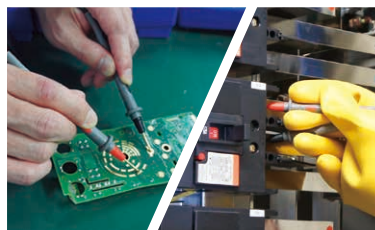
導通チェック、過入力時に赤色 LED 点灯とブザー音で直感的に確認
