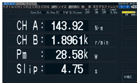
モータ解析画面 (トルク、回転数、モータパワー、すべり) CH B にエンコーダの Z 相パルスを入力すると電気角、B 相パルスを入力すると回転方向を測定できます
