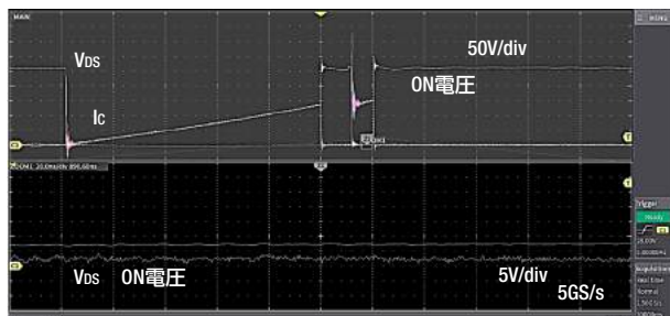
パワーデバイス (GaN) のスイッチング波形とON電圧 (Vds) の拡大波形
