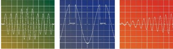
LIST/PULSE/STEPモードで瞬低/瞬断/ディップなどの
