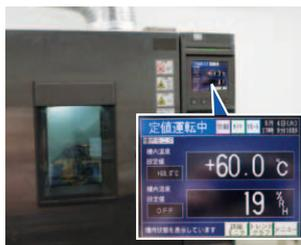
規定した温度範囲で長時間の動作や正常に測定できるかを確認します。
