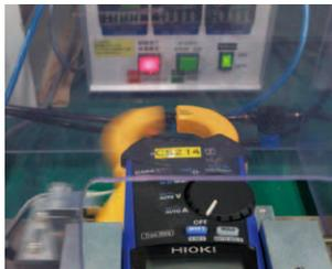
1回/秒のスピードで開閉を規定回数繰り返します。さらに、破壊するまで試験して実力を把握。堅牢性を向上させます。
