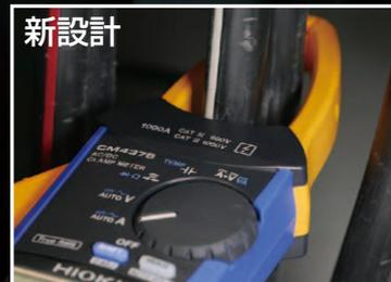
従来のクランプセンサは先端方向の寸法が短く、ダブル配線を挟むことができませんでした。ダブル配線を考慮し先端方向を長くした形状で、挟める範囲を拡大しました。
