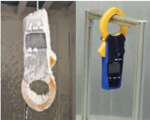
内部を減圧して粉塵をかける防塵試験、様々な方向から水をかける防水試験を実施。粉塵や水の侵入具合を調べます。
