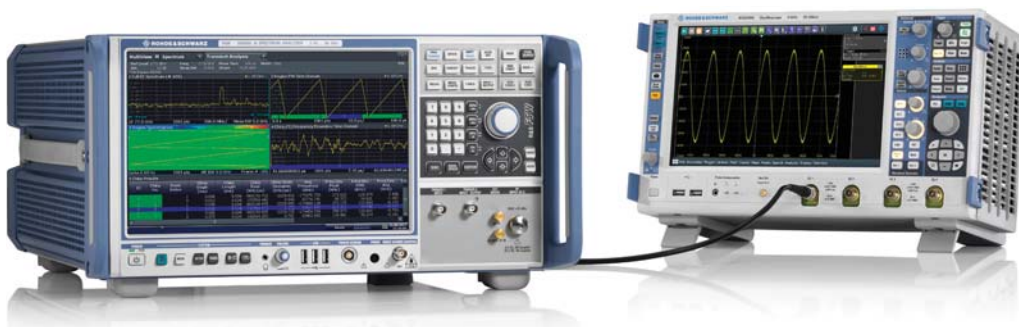
図6：外付けデジタイザとしてR&S®RT02064オシロスコープと一緒に使用されるR&S®FSW-B5000ハードウェア・オプションを装備したR&S®FSW85信号およびスペクトラム・アナライザは、5 GHzの信号解析帯域幅を提供します。
