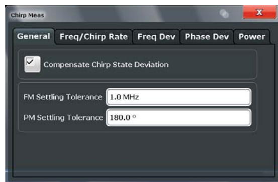
図13：デフォルトでは、測定されたチャープレートがチャープ直線性測定を実行するために使用され、平均チャープ状態からのずれが補償されます。
