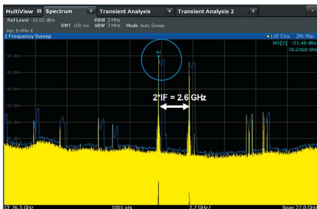
図3：R&S®FSW43に接続されたR&S®FS-Z90外付けハーモニック・ミキサで測定した60 GHz ～ 90 GHzのスペクトラム。76 GHzの希望信号は500 MHz幅です。最も近い画像は、スペクトラム・アナライザの中間周波数の2倍になります。他の不要な混変調信号およびそのイメージも存在します。
